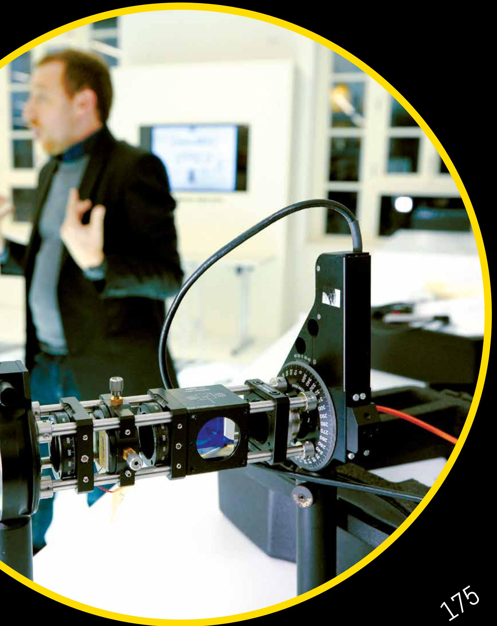
*La ruota fotonica è un nuovo dispositivo sviluppato dalla collaborazione fra diverse Università: un ingranaggio capace di far sì che la polarizzazione della luce ruoti più velocemente. È ottenuta da un congegno che utilizza un cristallo liquido, chiamato “q-plate”, che permette una manipolazione innovativa ed efficace della luce. La ruota fotonica ha un alto potenziale nelle applicazioni industriali, sia in termini di metrologia quantistica che di comunicazione quantistica.*
